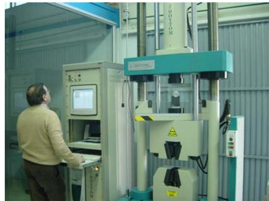
Fig.19. Ensayo a esfuerzo cortante. Centro tecnológico IES-SEP La Garrotxa.
